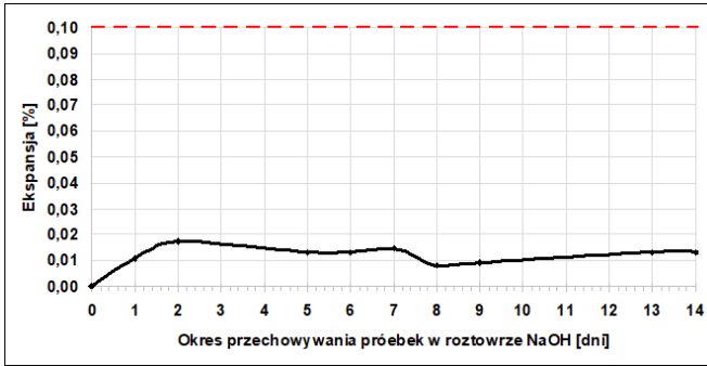
Rys. 8. Ekspansja zaprawy z słuczką szklaną wg ASTM C 1260 [16]
