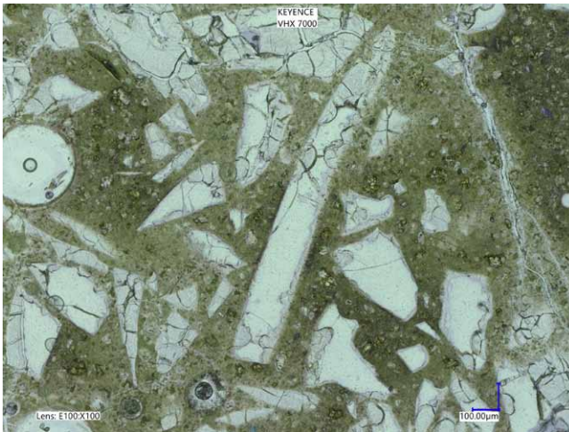
Rys. 9. Spękania w 0,5-roczej zaprawie
