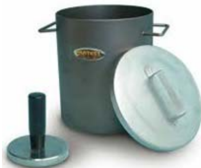
Fot. 7. Sprzęt do badania odsączania wody z mieszanki betonowej wg ASTM C232
