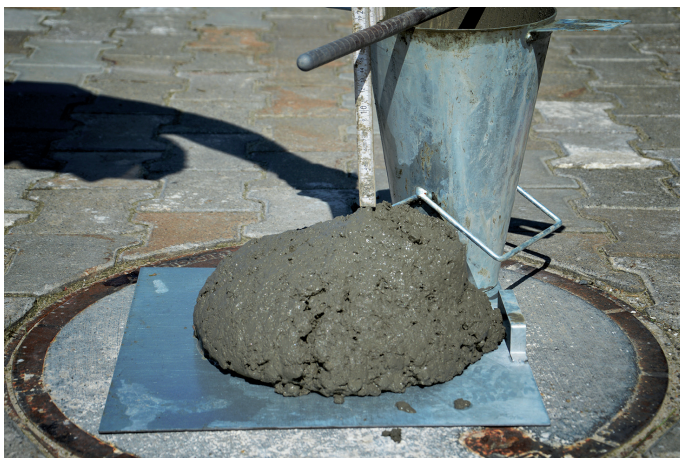
Fot. 1. Opad stożka uzyskany przy wykorzystaniu chemii konwencjonalnej
