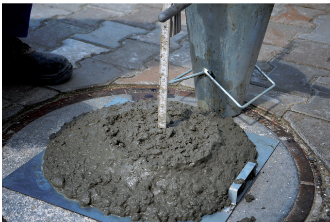
Fot. 2. Opad stożka uzyskany przy wykorzystaniu domieszki PCE
