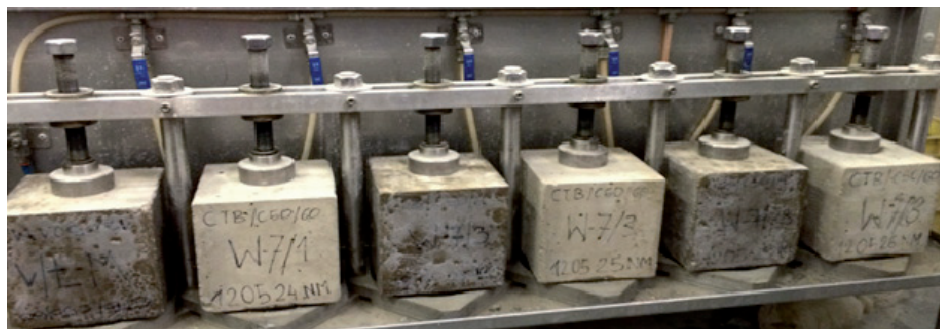
Fot. 1. Badanie głębokości penetracji wody na próbkach z powłoką i bez powłoki [12]
