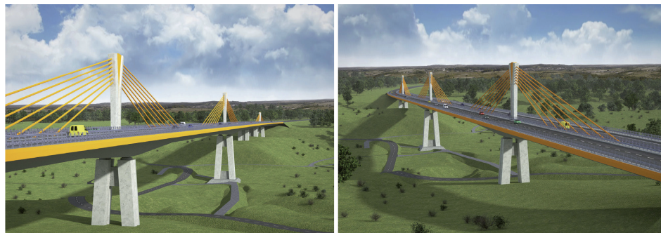
Fot. 9. Koncepcja mostu typu extradosed o rozpiętości 206 m (autor: T. Stefanowski, Transprojekt Gdański)
