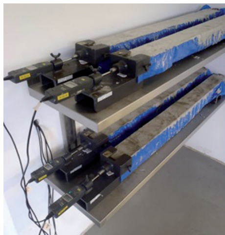
Fot. 1. Pomiar skurczu wg wewnątrzlaboratoryjnej procedury badawczej
