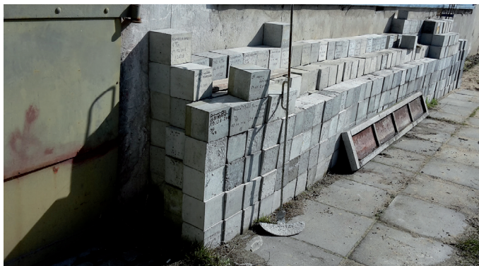
Fot 1. Przykład nieprawidłowego przechowywania próbek betonowych w jednej z wytwórni betonu towarowego
