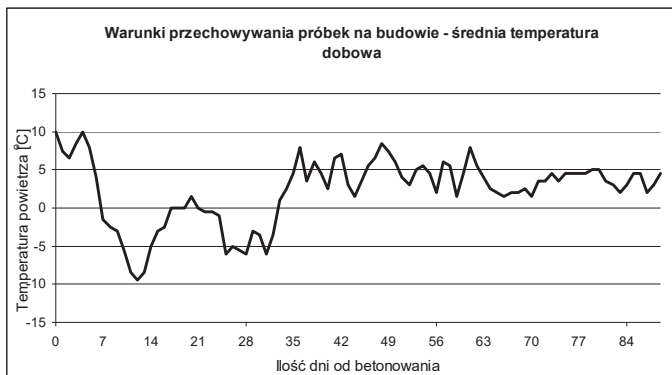
Rys. 11. Warunki przechowywania próbek na budowie – zestawienie średnich temperatur dobowych w okresie od 1 do 90 dnia od betonowania
