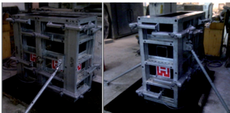
Fot. 5. Forma do badania parcia mieszanki samozagęszczalnej na deskowanie – model ściany
