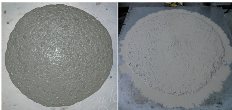
Fot. 1. Przykład mieszanki stabilnej VSI0 i rozsegregowanej VSI3
