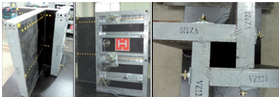
Fot. 4. Forma do badania parcia mieszanki samozagęszczalnej na deskowanie słupa, widoczne umieszczenie czujników ciśnienia
