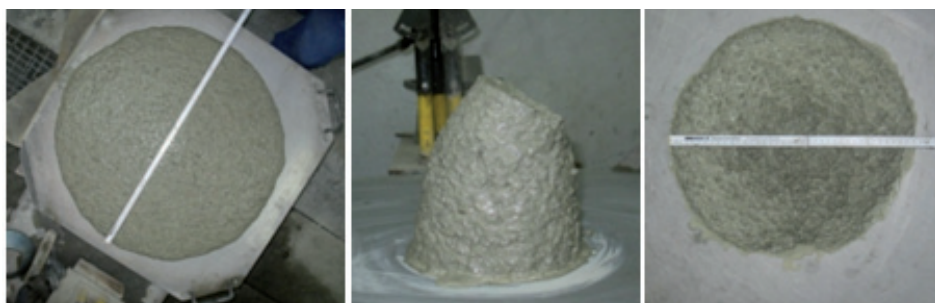
Fot. 3. Badanie efektu sztywnienia za pomocą testu rozplywu; po lewej rozplyw bezpośrednio po zakończeniu mieszania, w środku rozplyw (opad stożka) po 20 min w spoczynku, po prawej rozplyw po ponownym zmieszaniu
