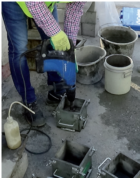
Fot. 2. Zagęszczanie próbki betonu za pomocą młota udarowego
