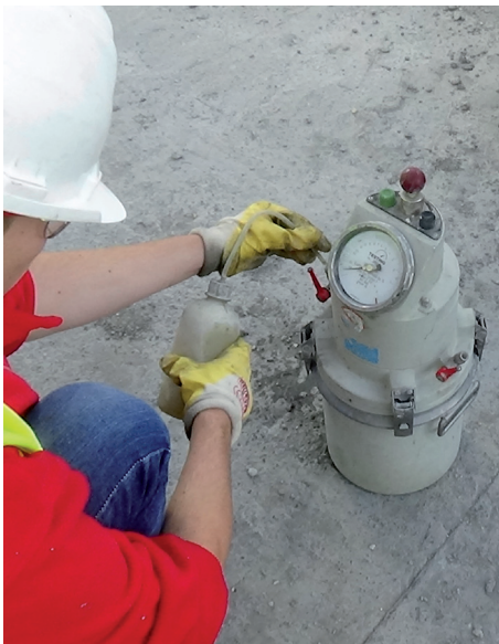
Fot. 3. Badanie napowietrzenia betonu
