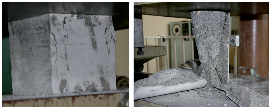
Fot. 3. Próbką kostkowa i walcowa po zniszczeniu w próbie ściskania
