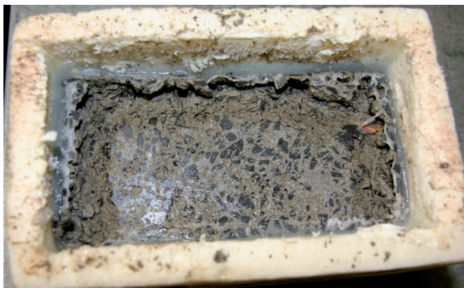
Fot. 4. Próbką po badaniu mrozoodporności w solach
