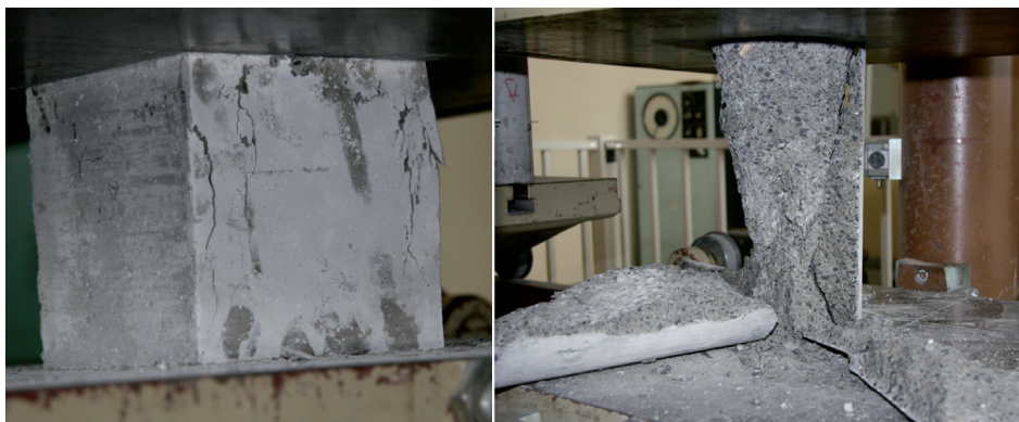
Fot. 1. Próbką kostkowa i walcowa po zniszczeniu w próbie ściskania
