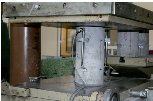
Fot. 3. Badanie modułu Younga za pomocą czujników LVDT i Demeca
