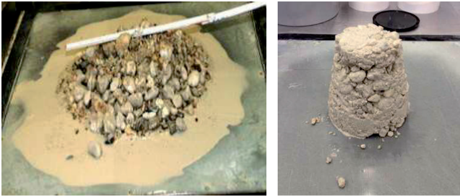
Rys. 4. Efekt działania polimerowej domieszki stabilizującej urobek żwirowo-piaskowy
