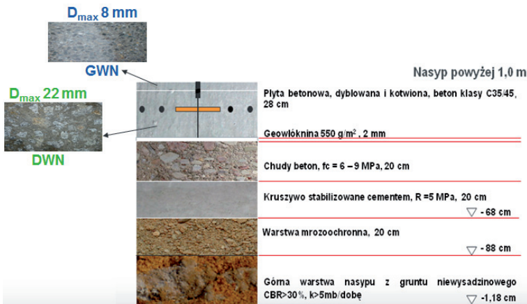
Rys. 2. Przykład przekroju nawierzchni dwuwarstwowej z eksponowanym kruszywem
