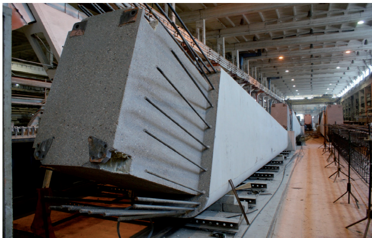
Rys. 9. Prefabrykowany słup wsporczy powłoki chłodni [1]
