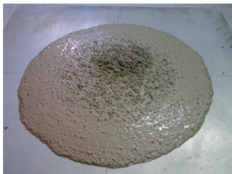
Fot. 1. a) Mieszanka M7 betonu ciężkiego w badaniu rozplwy i b) zbliżenie na krawędź
