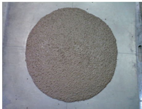
Fot. 1. a) Mieszanka M7 betonu ciężkiego w badaniu rozplwy i b) zbliżenie na krawędź
