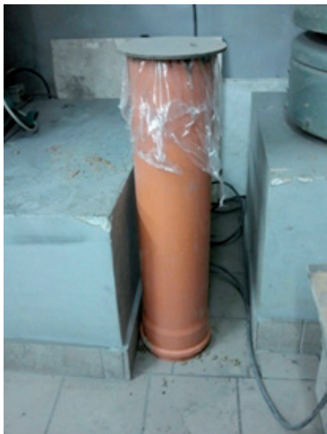
Fot. 3. a) Tuba segregacyjna i b) przekrój przez próbkę ciężkiego betonu wyjętą z tuby
