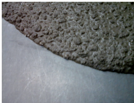
Fot. 1. a) Mieszanka M7 betonu ciężkiego w badaniu rozplwy i b) zbliżenie na krawędź
