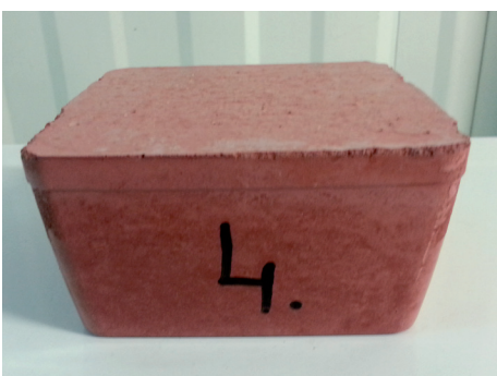
Fot. 6. Beton barwiony w masie czerwony
