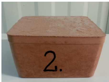
Fot. 4. Beton barwiony w masie brązowy
