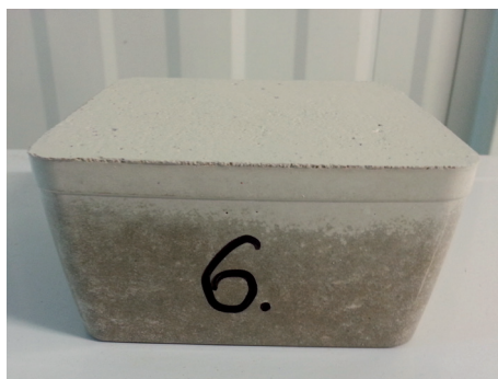
Fot. 8. Beton standardowy szary
