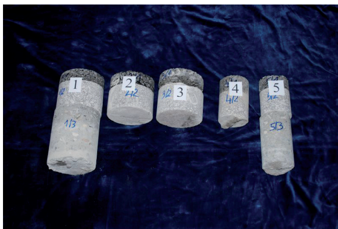
Fot. 3. Odwierty rdzeniowe pobrane z badanych płyt lotniskowych
