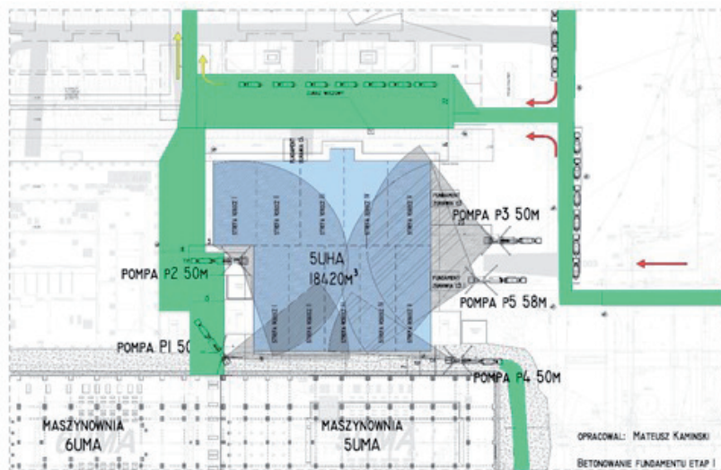
Rys. 5. Plan betonowania i rozmieszczenia pomp – etap I
