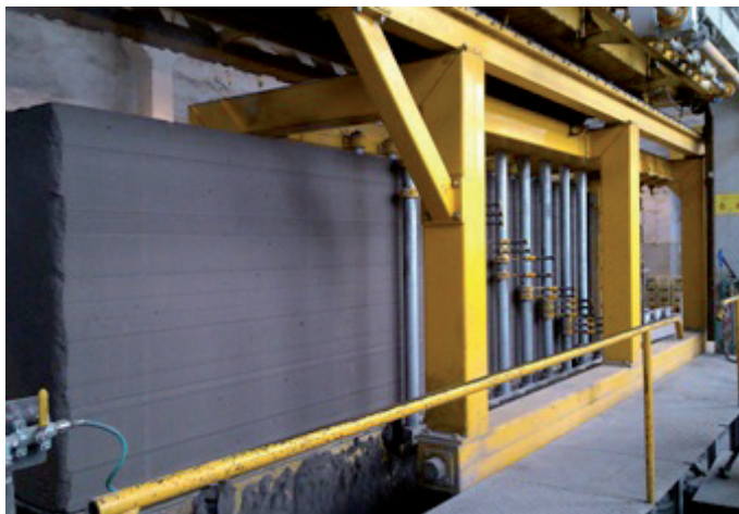
Fot. 1. Blok masy betonu komórkowego na stanowisku krojenia
