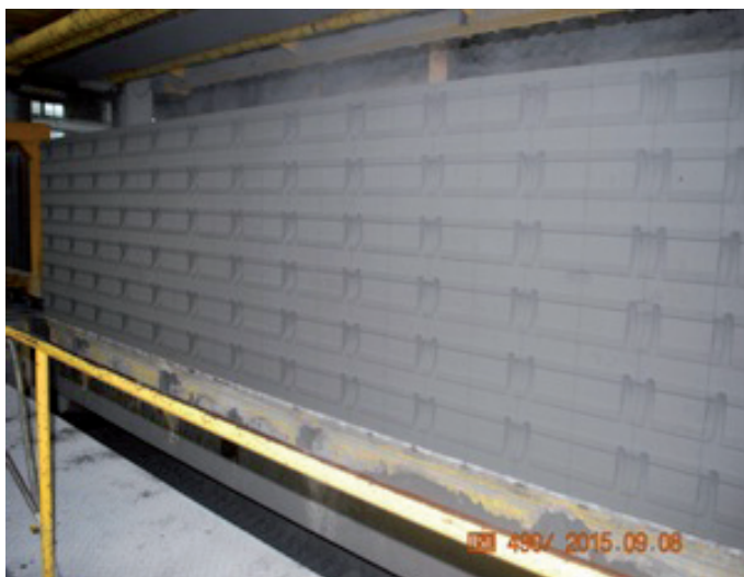
Fot. 2. Widoczne wyprofilowania na pióro i wpust oraz uchwyty montażowe w masie betonu
