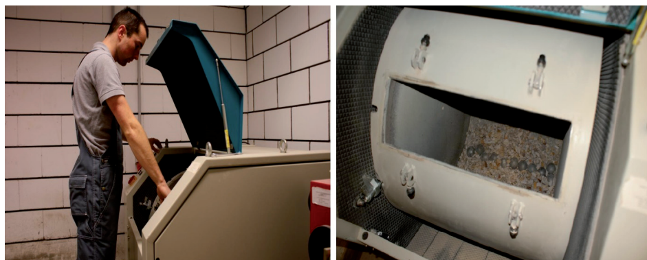
Fot. 3 i Fot. 4. Laborant w trakcie wykonywania badania ścieralności w bębnie Los Angeles oraz wnętrze bębna wraz z kruszywem i kulami
