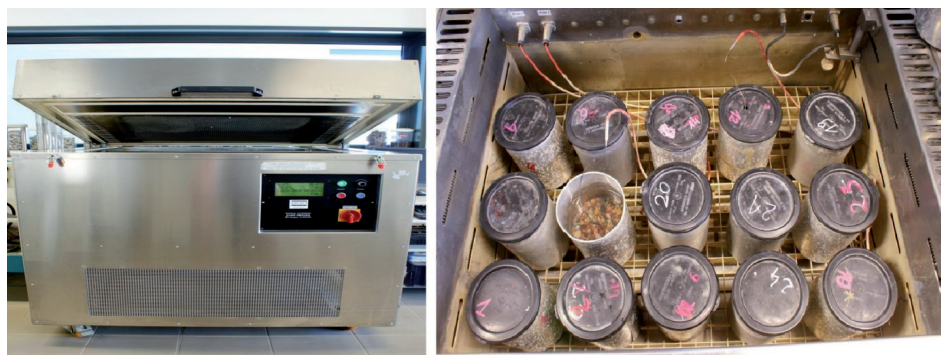
Fot. 1 i Fot. 2. Komora do badania mrozoodporności kruszywa oraz pojemniki z kruszywem w czasie badania
