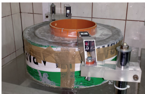
For. 2. Badanie swobodnego skurczu liniowego betonowych próbek pierścieniowych z wykorzystaniem czujników laserowych
