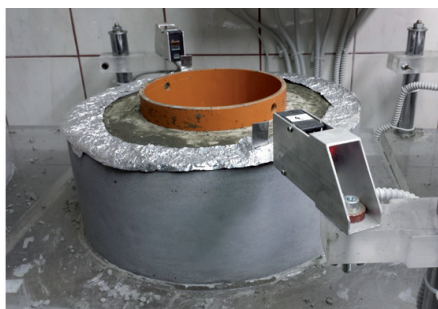
For. 2. Badanie swobodnego skurczu liniowego betonowych próbek pierścieniowych z wykorzystaniem czujników laserowych
