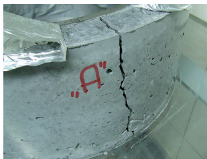
Rys. 6. Pomiar oddziaływania skurczu ograniczonego wg ASTM C 1581-09 C: a) przekrój przez stanowisko badawcze, b) próbka po pęknięciu – zakończeniu badania
