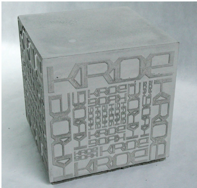
Fot. 11. Bryła ze strukturalnie formowaną powierzchnią, ścianki o grubości 2 cm
