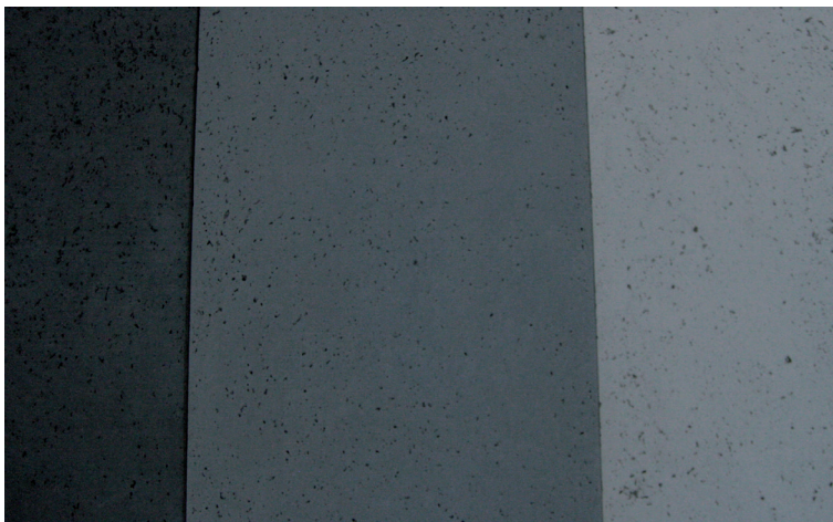
Fot. 1. Płyty elewacyjne barwione czarnym pigmentem, różne dawkowanie
