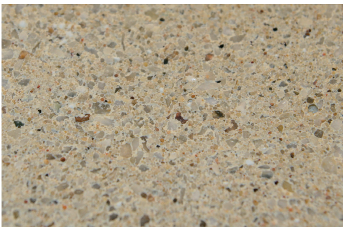
Fot. 7. Powierzchnia płyty okładzinowej z eksponowanym kruszywem
