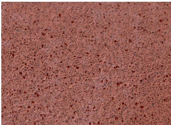
Fot. 5. Powierzchnia okładziny GRC piaskowanej kwarcytem o średnicy <math>< 1\text{ mm}</math>
