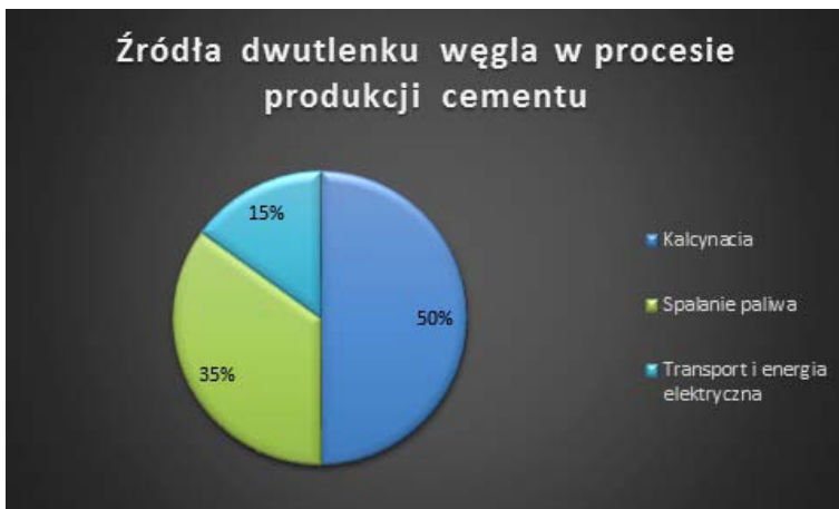
Rys. 2. Źródła dwutlenku węgla w procesie produkcji cementu [12]
