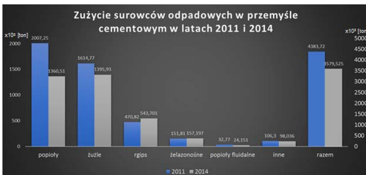
Rys. 4. Zużycie surowców odpadowych w Polsce w latach 2011 oraz 2014 [13, 14]
