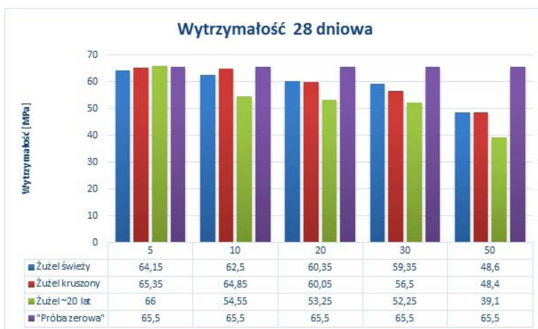
Rys. 8. Wytrzymałość cementów po 28 dniach twardnienia
