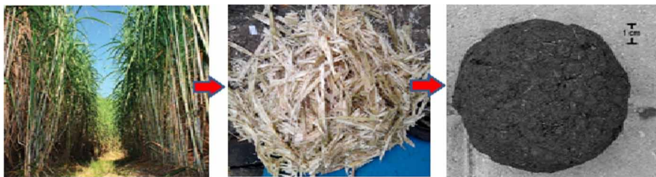
Rys. 3. Etapy pozyskiwania popiołu z wycłoczyn z trzciny cukrowej [24]
