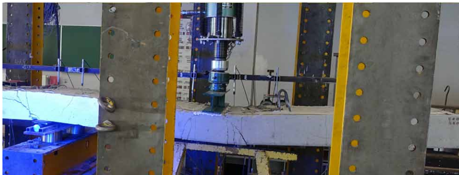
Rys. 7 Płyta B1-G-E po zniszczeniu
